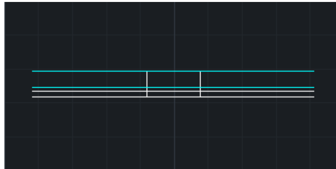
Rys. 1.19 Ściana zakończona połączeniem I
