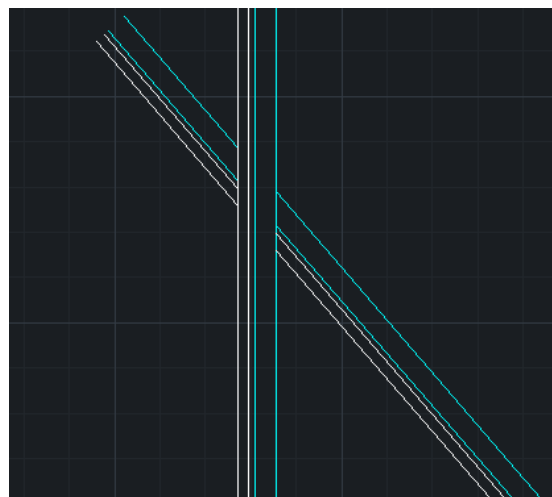
Rys. 1.13 Ściana zakończona połączeniem X
