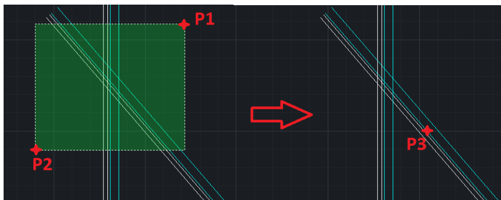
Rys. 1.12 Kolejność wprowadzania punktów dla połączenia X
