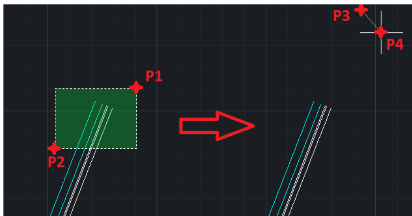
Rys. 1.15 Kolejność wprowadzania punktów dla połączenia C
