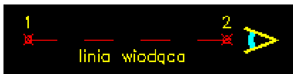
Rys. 1.2 Schemat sposobu odkładania ściany od linii wiodącej
