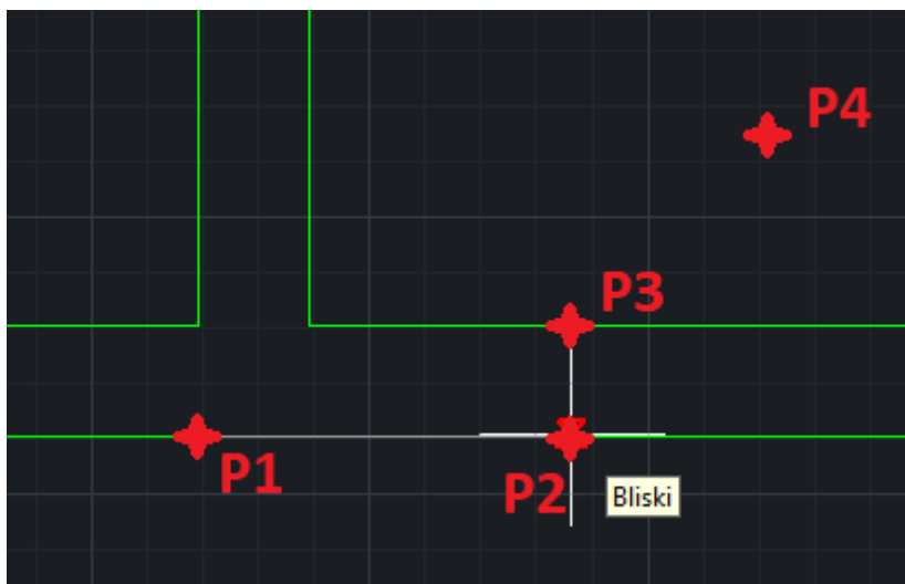
Rys. 1.52 Kolejność wprowadzania punktów przy wstawianiu drzwi w rzucie
