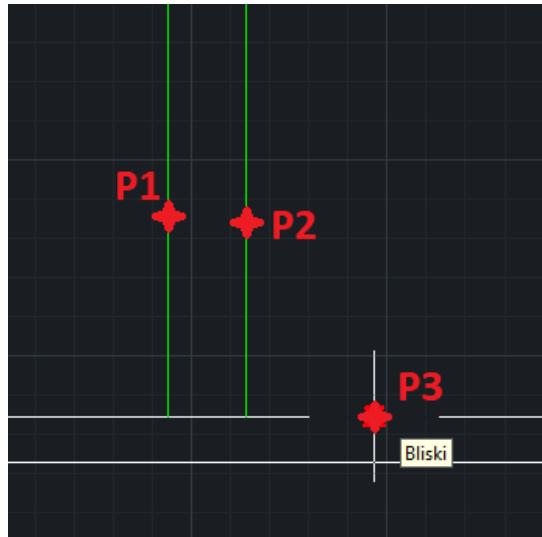
Rys. 1.39 Kolejność wprowadzania punktów przy wstawianiu okna w przekroju
