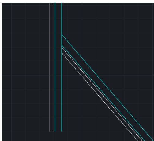
Rys. 1.10 Ściana zakończona połączeniem T
