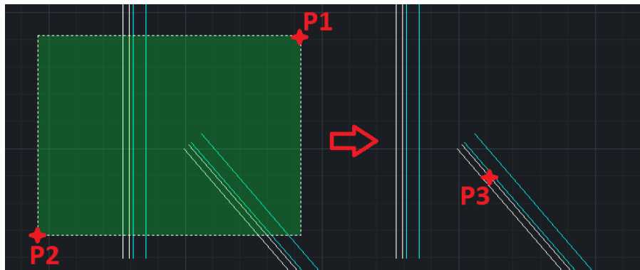
Rys. 1.9 Kolejność wprowadzania punktów dla połączenia T
